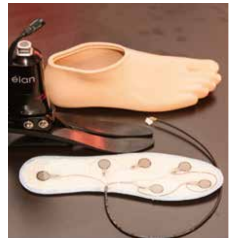
Abb. 6 Sohle mit Sensoren.
