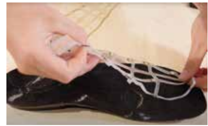
Abb. 2 3D-gedruckte Einlegesohle mit eigens dafür vorgesehenen Vertiefungen, in die das Sensornetz einfach eingeklebt werden kann.
