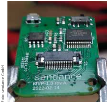
Abb. 3 Ausleseelektronik, welche die Druckdaten ausliest und an ein bluetoothfähiges Endgerät drahtlos überträgt.
