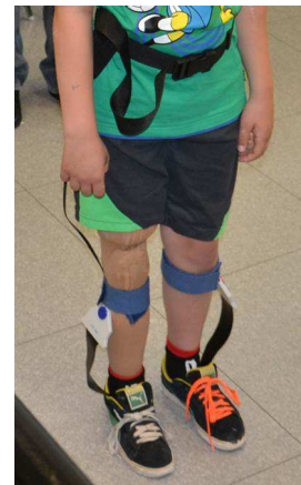
Abb. 4: Prothesenträger mit Sensorsohlen für pedobarometrische Analyse
